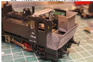
Beim Verkleben des Kohlekastens ist es empfehlenswert, das Gehäuse auf das Fahrwerk aufzusetzen.
