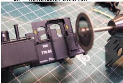
Der Trennschnitt ist entlang der rückseitigen Führerhauskante zu setzen. Die Trennstelle ist anschließend zu ebenen und zu säubern, um an den Kohlekasten exakt ansetzen zu können.
