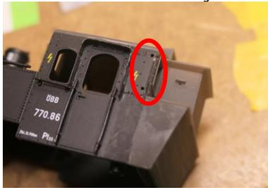
Am Gehäuse sind die Öffnungen der am Großserienmodell vorhandenen Griffstangen zu verschließen.
