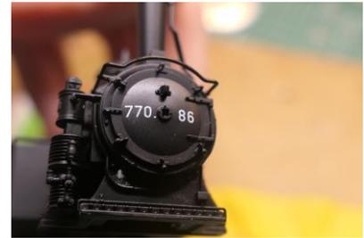
Das Handrad der Rauchkammertür ist durch das mitgelieferte Handrad zu tauschen
