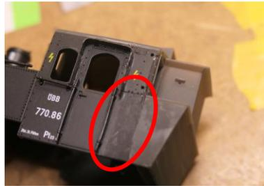
Am Gehäuse sind Nietreihen zu entfernen, da der untere Teil beim Vorbild der 770.86 als Schweißkonstruktion ausgeführt wurde.
